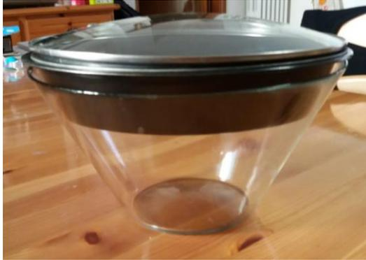
Per realizzare il ricevitore consigliamo l'utilizzo di un sistema composto da un'insalatiera in vetro, una tortiera, un coperchio in acciaio verniciato di nero ed un ulteriore coperchio in vetro.
