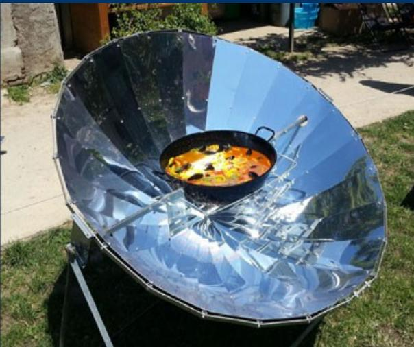
La cucina ad energia solare funziona tramite un riflettore parabolico che concentra i raggi del sole sulla pentola e la riscalda.
