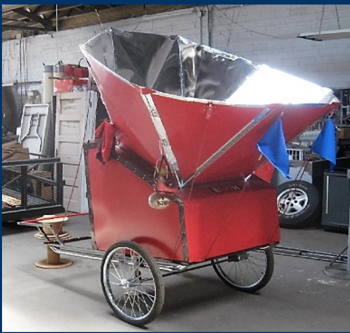
Forno solare di Maria Telkes ( T > 220^{\circ}\text{C} )
