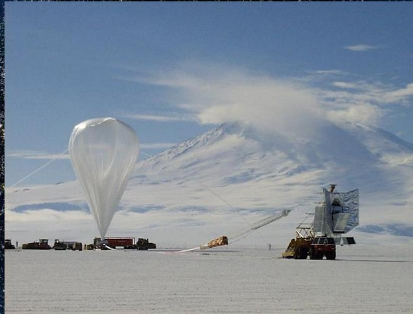
Il pallone da alta quota utilizzato per portare ad altezza suborbitale il telescopio atto a eseguire il progetto BOOMERanG
